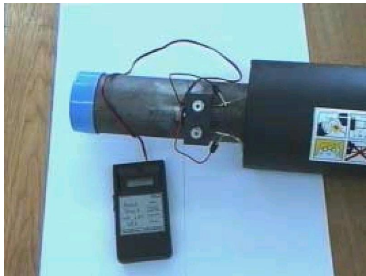
8 pav. Portatyvinis vamzdyno tikrinimo prietaisas
